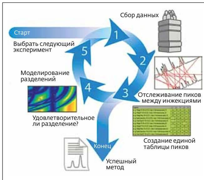
Рис.3. Схема разработки хроматографического метода разделения сложных смесей при помощи ACD/AutoChrom
